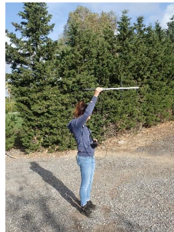
Photo 7: manquement de l'antenne de radio-télémetrie pointée dans la direction du signal le plus intense
